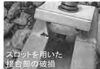
第2図 アルミ製架台の被害事例(2016年、鹿児島県)
