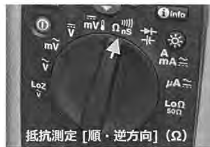
(b) マルチメータの抵抗測定
