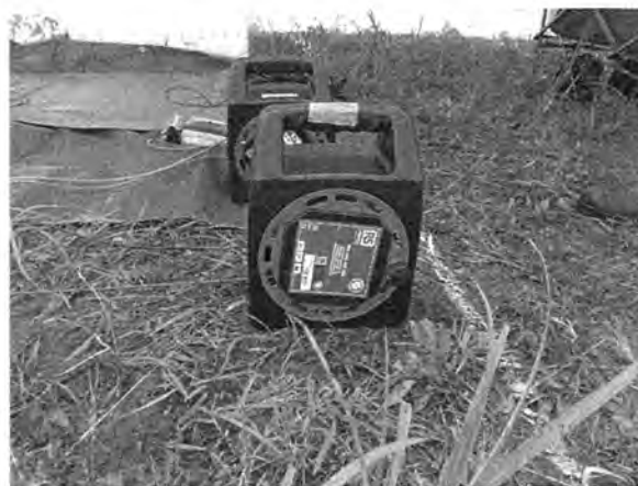
(a) 延長リールの例(50m、1Ω程度)
