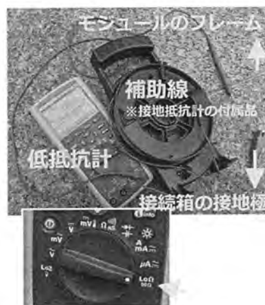
(b) 低抵抗計の接続と設定
