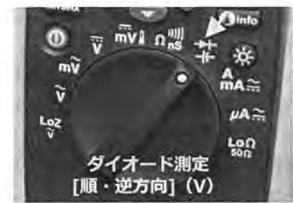
(c) マルチメータのダイオード測定モード
